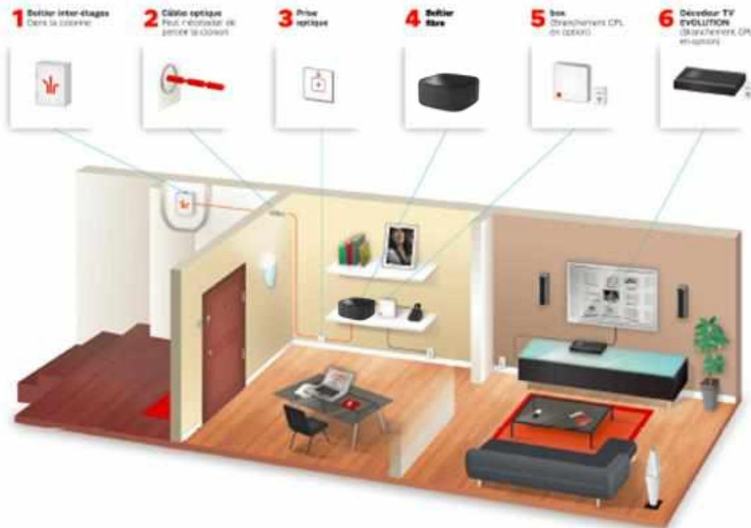
Le technicien va **percer un trou au plus près de la porte d'entrée** pour faire entrer le câble de la Fibre.
